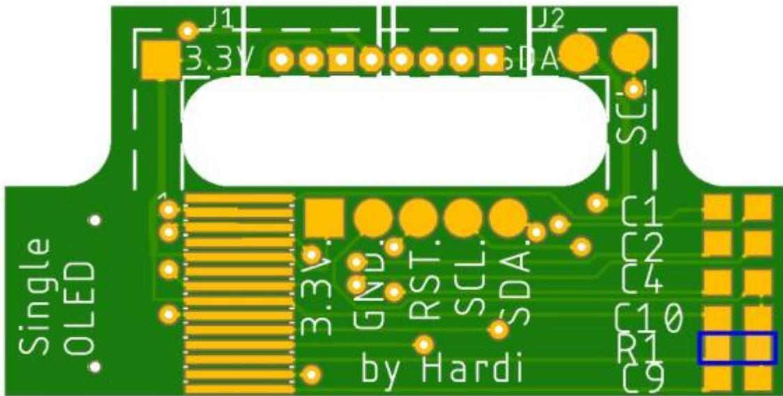
gefolgt von den Kondensatoren C9 und C10 ( $4,7\mu\text{F}$ ),
