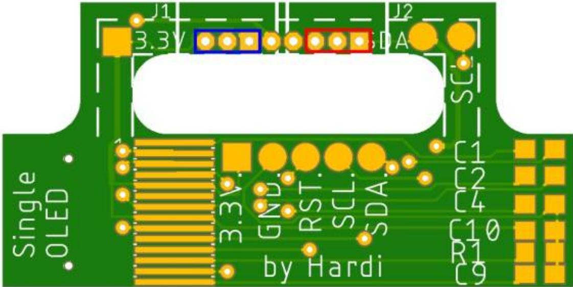
Bei der Verwendung des sechspoligen Verbinders J2&J3, kommt die Buchse in diese Lötpunkte.
