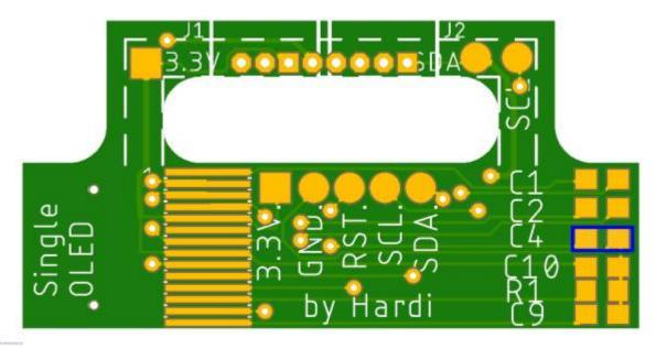
und den Kondensatoren C1 und C2 (470nF).
