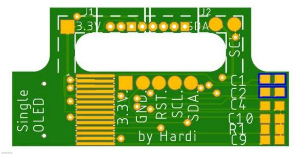
Zum Anlöten wurden auf der Platine zwei kleine Löcher vorgesehen durch die man einen Draht steckt. Mit diesen wird dann das Displayflexkabel an der richtigen Position fixiert. Dann muss man nur noch winzige Korrekturen machen und kann die Leiterbahnen verbinden. Dazu mit der obersten Leiterbahn beginnen und schauen das diese nach dem anlöten noch sauber ausgerichtet ist. Erst nachdem die Position passt, kann die nächsten Kontakte mit winzigen Mengen Zinn verlöten.
