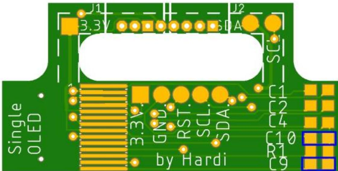
dem Kondensator C4 (2,2 $\mu$ F)
