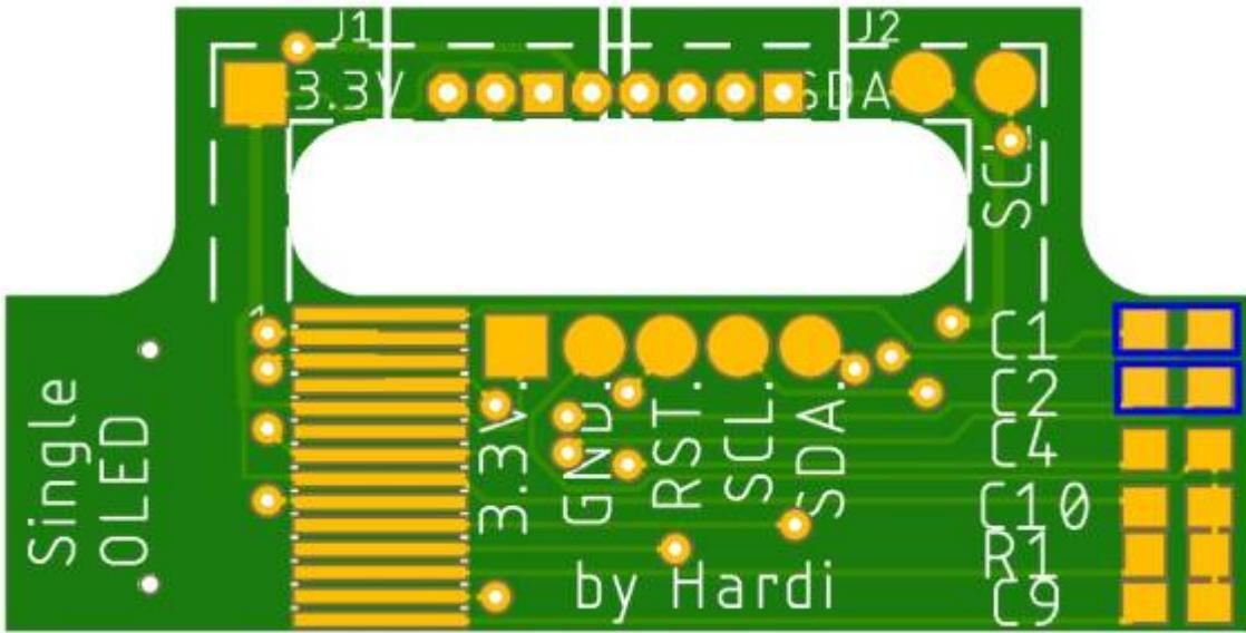
Zum Anlöten wurden auf der Platine zwei kleine Löcher vorgesehen durch die man einen Draht steckt. Mit diesen wird dann das Displayflexkabel an der richtigen Position fixiert. Dann muss man nur noch winzige Korrekturen machen und kann die Leiterbahnen verbinden. Dazu mit der obersten Leiterbahn beginnen und schauen das diese nach dem anlöten noch sauber ausgerichtet ist. Erst nachdem die Position passt, kann die nächsten Kontakte mit winzigen Mengen Zinn verlöten.
