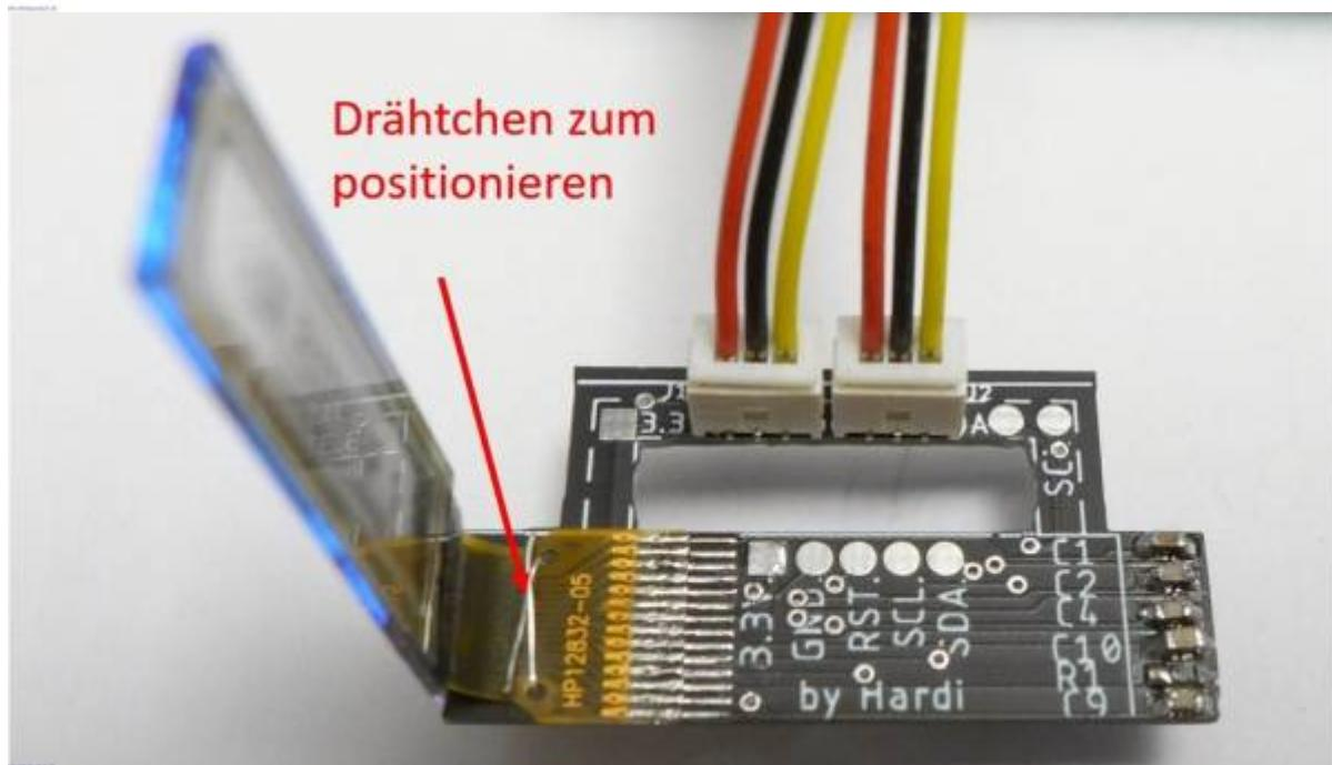
Die letzten Bauteile sind die beiden Steckverbinder welche oben im Griff eingelötet werden.
