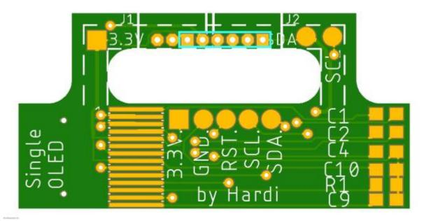
Die Belegung der Kontakt ist wie auf dem nachfolgenden Bildern beschrieben. SDA2 wird dabei für die Platine mit 1x Display nicht benötigt und muss nicht verbunden werden.
