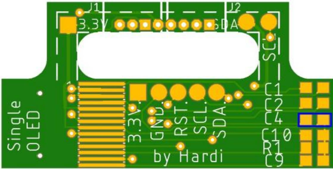
und den Kondensatoren C1 und C2 (470nF).
