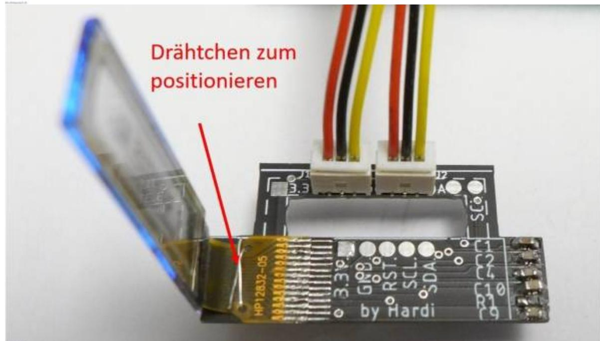
Die letzten Bauteile sind die beiden Steckverbinder welche oben im Griff eingelötet werden. Wenn man die beiden einzelnen dreipoligen Verbinder nimmt werden die folgenden Lötpunkte verwendet.
