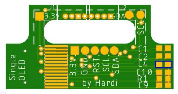
und den Kondensatoren C1 und C2 (1.0µF).
