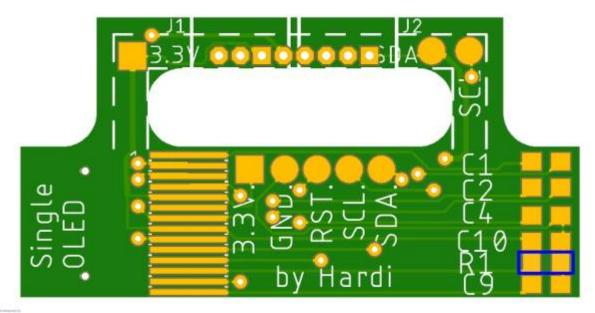
gefolgt von den Kondensatoren C9 und C10 (4,7μF),
