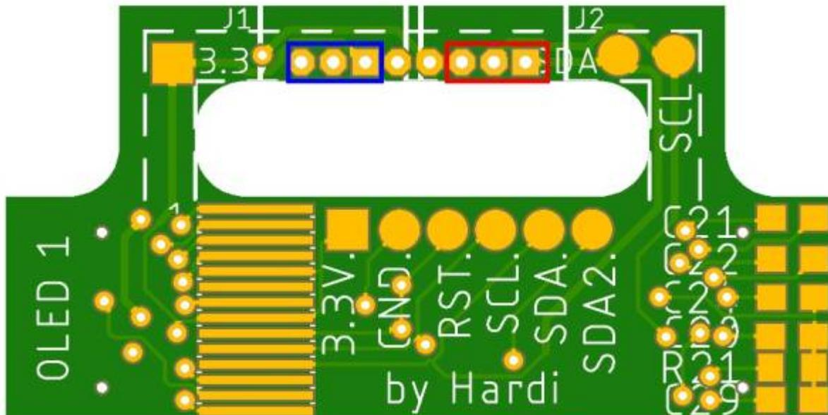
Bei der Verwendung des sechspoligen Verbinders J2&J3, kommt die Buchse in diese Lötunkte.
