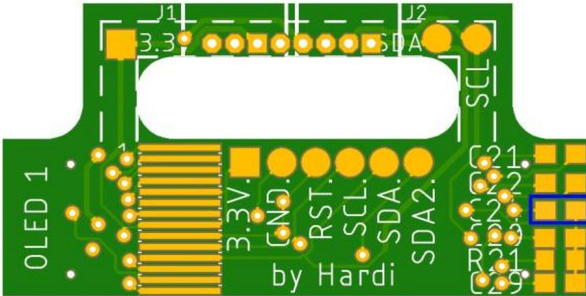
und den Kondensatoren C21 und C22 (1.0µF).
