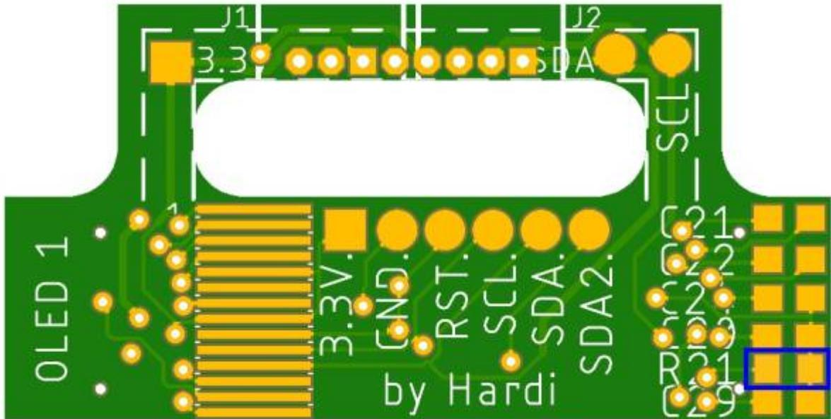
gefolgt von den Kondensatoren C20 und C29 ( $4,7\mu\text{F}$ ),
