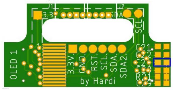
und den Kondensatoren C21 und C22 (1.0μF).
