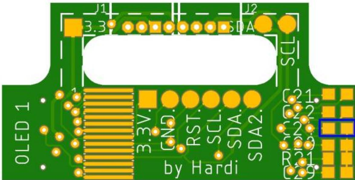
und den Kondensatoren C21 und C22 (1.0µF).
