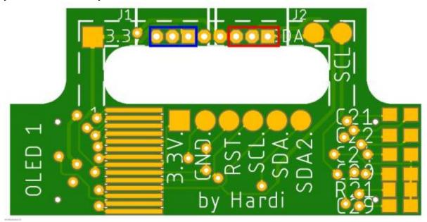
Bei der Verwendung des sechspoligen Verbinders J2&J3, kommt die Buchse in diese Lötpunkte.
