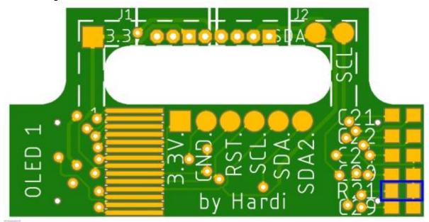
gefolgt von den Kondensatoren C20 und C29 (4,7µF),
