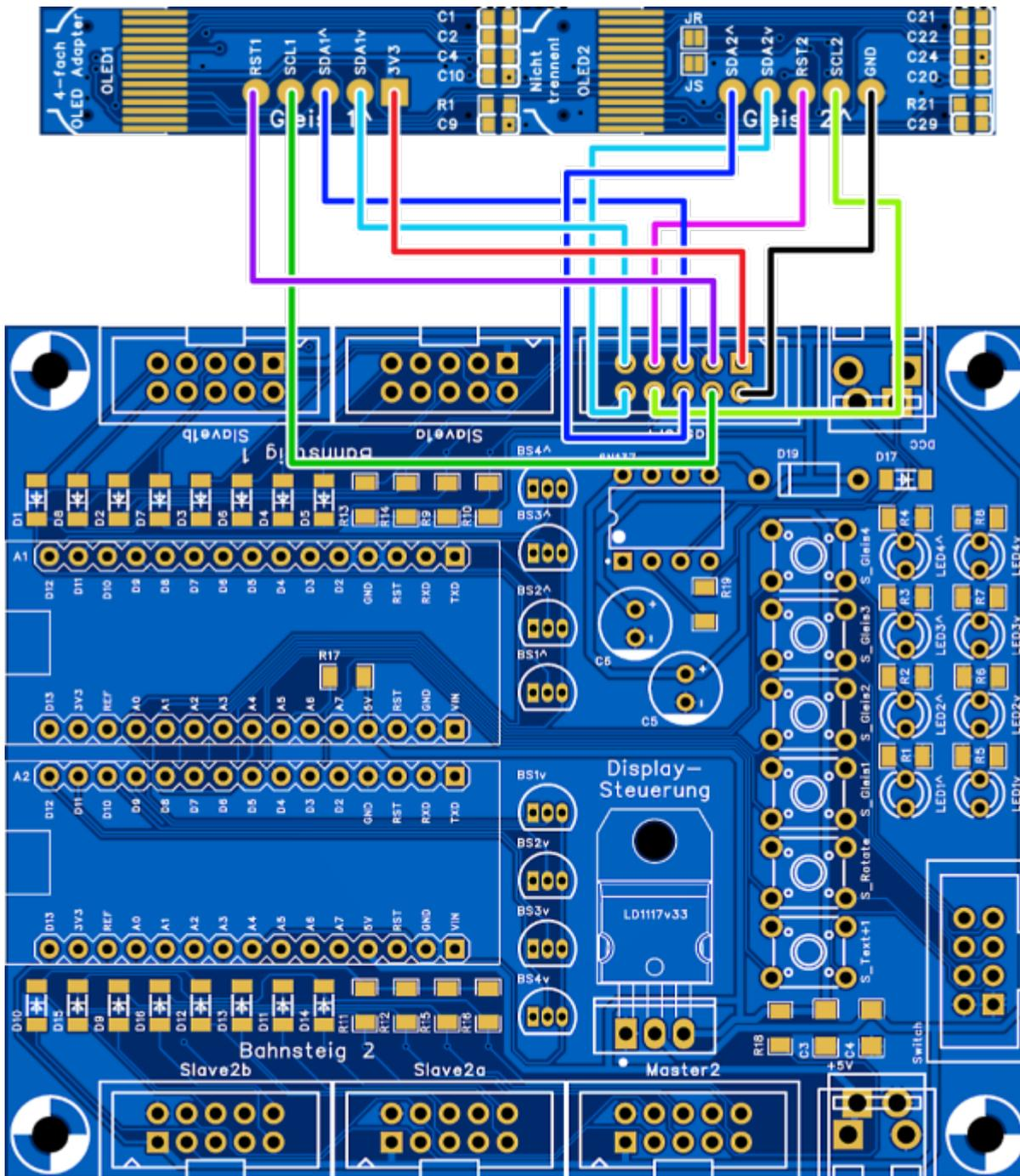
Das oben gezeigte Anschluss-Schema gilt für alle sechs Wannenstecker. Auf diese Weise können bis zu 24 Displays an die Steuerung abgeschlossen werden.
