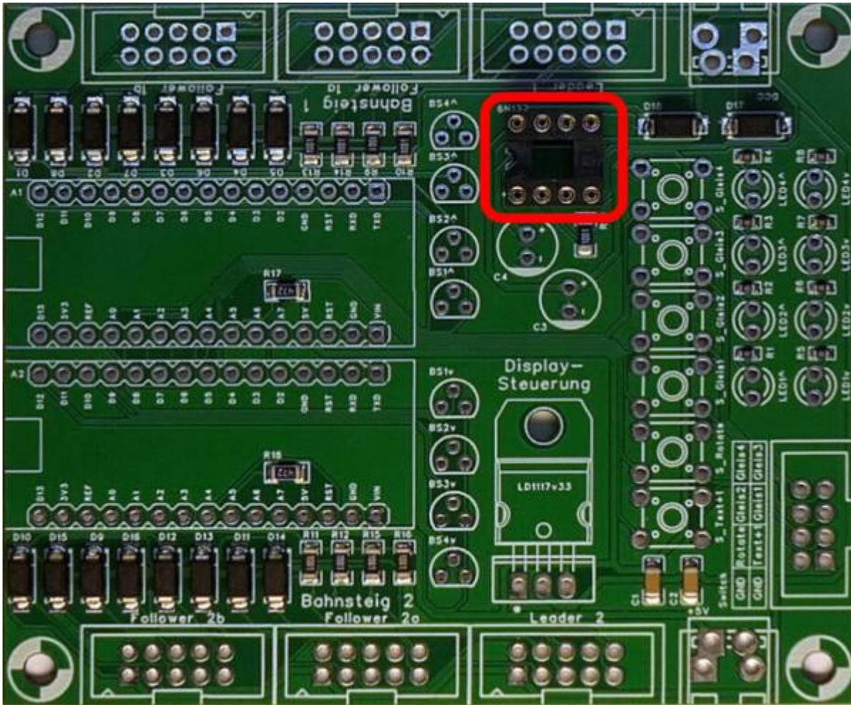
6) Spannungsregler LD1117v33 mit Wärmeleitpaste, Schraube M3x5 und Mutter M3 anbringen, dann löten
