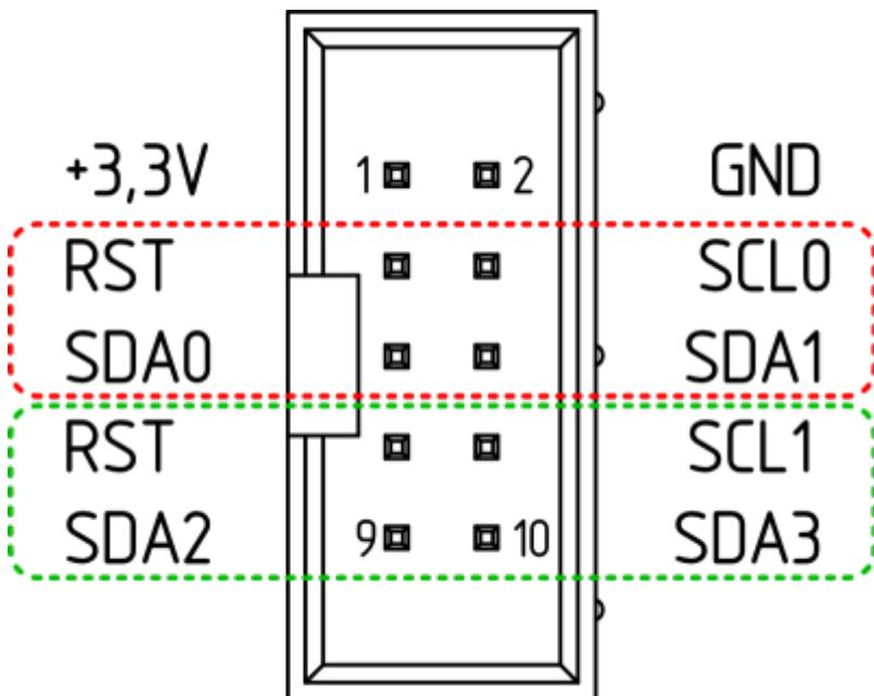
Der Wannenstecker ist für den Anschluss eines Vierfach-Displays optimiert. Hier teilen sich dann vier OLEDs auf einem OLED-Adapter (750) die Anschlüsse Plus, Minus, Rest und SCL.
