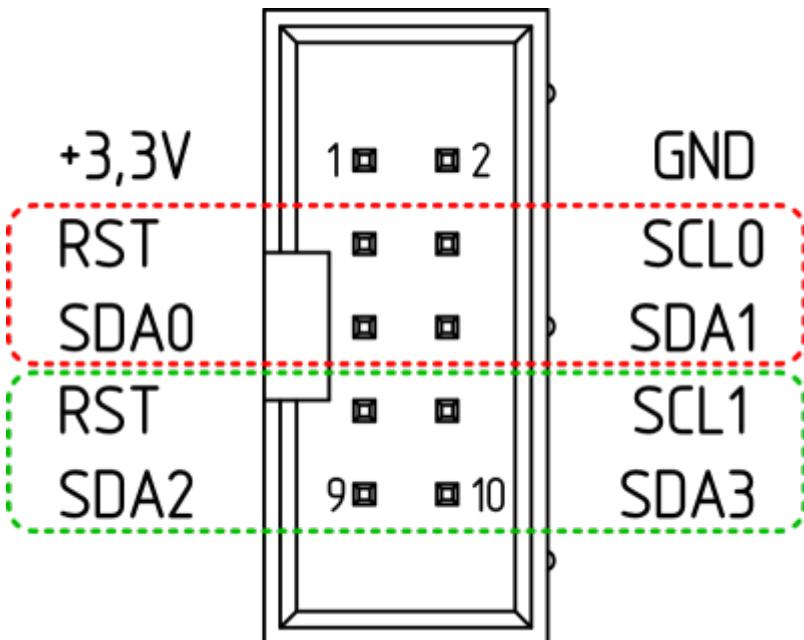
Der Wannenstecker ist für den Anschluss eines Vierfach-Displays optimiert.
