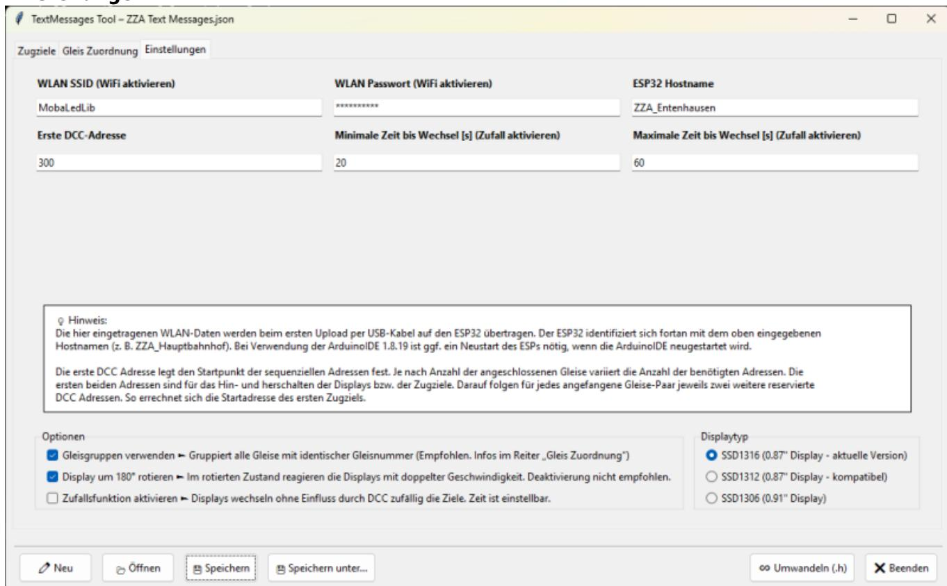
Im Reiter Einstellungen werden als erstes die WLAN Zugangsdaten eingegeben, um den Sketch kabellos übertragen zu können. Die erste Übertragung muss selbstverständlich per USB Kabel erfolgen, da die Zugangsdaten noch nicht übermittelt wurden. Da die MobaLedLib nach wie vor die Arduino IDE 1.8.19 voraussetzt, ist es zwingend erforderlich, dass der ESP32 erst nach dem Öffnen der Arduino IDE gestartet wird. Es empfiehlt sich daher, die ZZA Steuerung über ein Relais schaltbar
