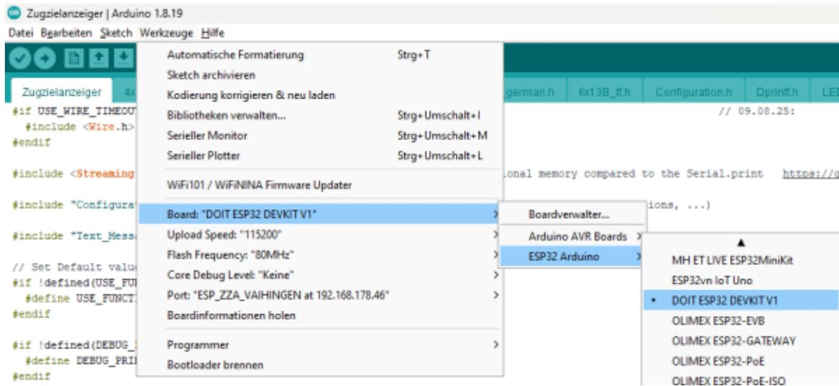
Der erste Upload **muss** per USB-Kabel erfolgen, weil der ESP32 die WLAN-Daten noch nicht kennt und sich somit noch nicht im WLAN melden kann. Dazu muss unter „Werkzeuge > Port“ der richtige serielle COM-Port eingestellt werden. Ab dem folgenden Upload kann hier dann auch unter Port auch die Netzwerk-Schnittstelle ausgewählt werden. Hier sieht man den ESP32 dann mit dem zuvor angegebenen ESP-Hostname.
