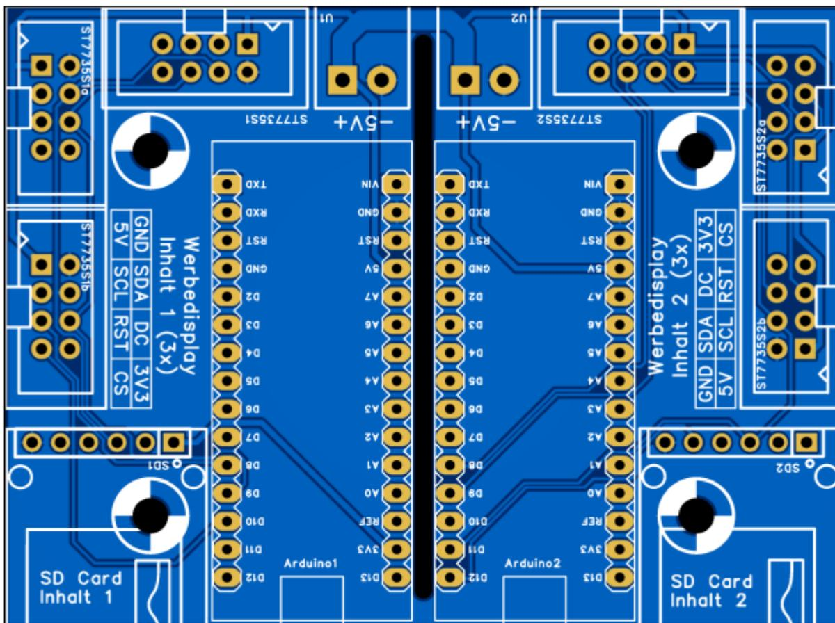
Die Anschlussklemme auf der Ausgangsseite wird nur benötigt, wenn die Adapterplatine in eine bestehende 5 Volt-Versorgungsleitung eingebunden wird (durchschleifen) oder wenn die Platine in zwei Hälften getrennt wird.
