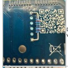
Das **Bild 2** zeigt den Einbau des Widerstandes, so kann er dann auch von der Unterseite der Platine gelötet werden.
