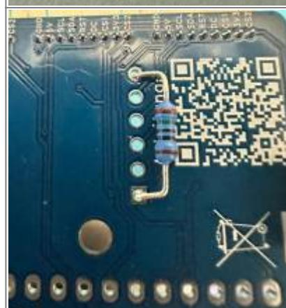
Das **Bild 2** zeigt den Einbau des Widerstandes, so kann er dann auch von der Unterseite der Platine gelötet werden.
