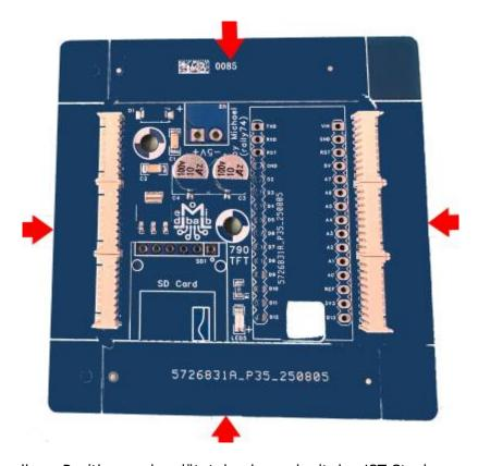
Alle Teile werden an ihren Positionen eingelötet, beginnend mit den JST-Steckern, gefolgt von SD-Card Reader, Arduino und der 3,5mm Klemme. Beim SD-Card Reader empfiehlt es sich, beim Löten einen Kunststoffring einer Stiftleiste vorn unter die Platine zu legen, damit sie parallel zur Platine bleibt.
