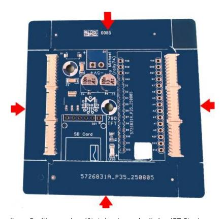
Alle Teile werden an ihren Positionen eingelötet, beginnend mit den JST-Steckern, gefolgt von SD-Card Reader, Arduino und der 3,5mm Klemme. Beim SD-Card Reader empfiehlt es sich, beim Löten einen Kunststoffring einer Stiftleiste vorn unter die Platine zu legen, damit sie parallel zur Platine bleibt.
