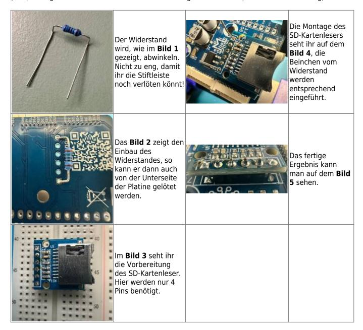
Für alle eingelöteten Bauteile gilt, sofern ihr das Gehäuse nutzen möchtet, das Kürzen der zu langen Pins!!
