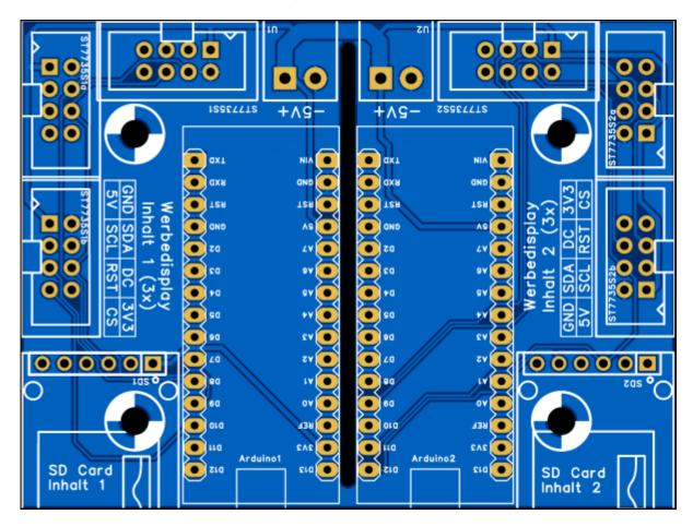
Die Anschlussklemme auf der Ausgangsseite wird nur benötigt, wenn die Adapterplatine in eine bestehende 5 Volt-Versorgungsleitung eingebunden wird (durchschleifen) oder wenn die Platine in zwei Hälften getrennt wird.
