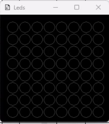
Der Simulator setzt aktuell einen Arduino voraus, den er simulieren soll. Von daher muss in der entsprechenden Excel-Mappe auch ein Arduino als Empfänger eingetragen sein. Ist in den Einstellungen ein ESP32 oder ein Raspi ausgewählt, funktioniert der Simulator nicht.
