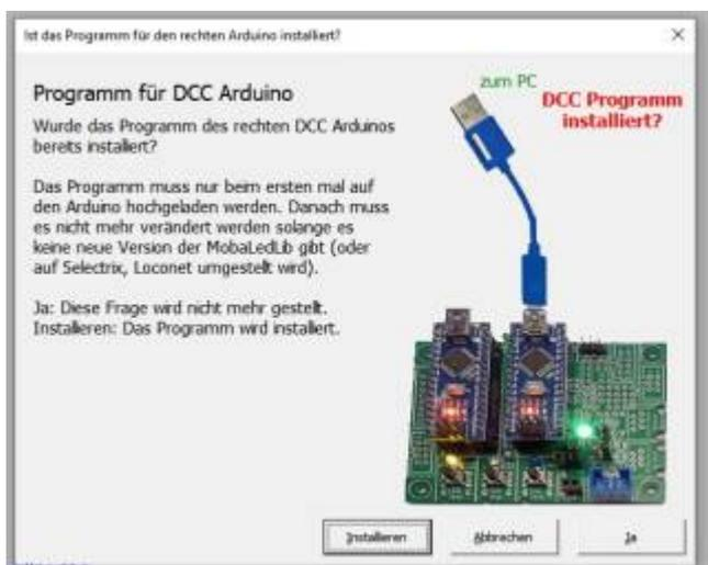
Im nächsten Schritt wird unsere Auswahl zum ARDUINO geschickt. Beim ersten Sendeversuch erfolgt die Aufforderung, den benutzten COM-Port festzulegen. Einfach den Anweisungen folgen und anschließend den „Z.Arduino schicken“ Knopf drücken.
