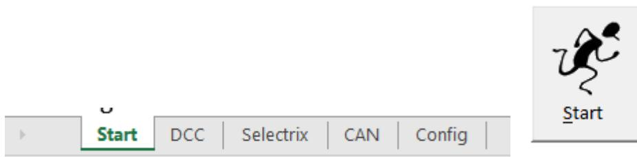
Bei einem Klick auf den Button „Start“ öffnet sich ein Auswahlmenü, welches ermöglicht eines der verschiedenen Systeme zur Steuerung zu verwenden. Ein Wechsel auf ein anderes System ist jederzeit möglich. Für Anfänger wird das System „DCC“ empfohlen, da es sehr einfach ist und die größte Verbreitung hat.
