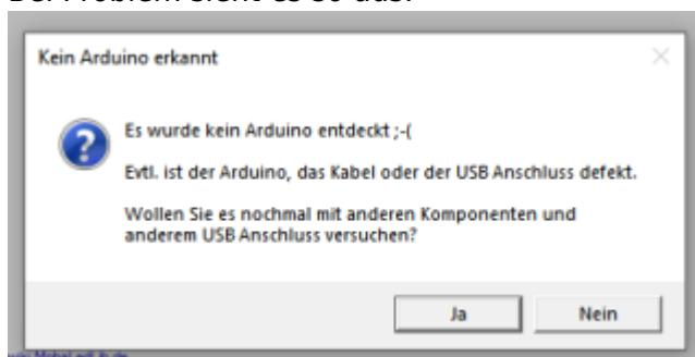
Der Vorgang zum Erkennen des COM-Ports kann auch über „Optionen“ → „USB Port erkennen“ angestoßen werden.
