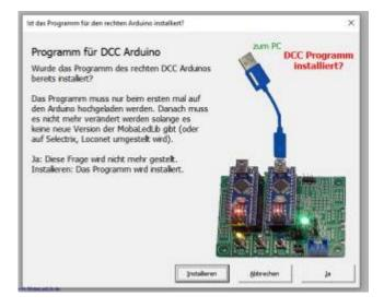
Beim ersten Sendeversuch erfolgt die Aufforderung, den benutzten COM-Port festzulegen. Einfach den Anweisungen folgen und anschließend den "Z.Arduino schicken" Knopf drücken.
