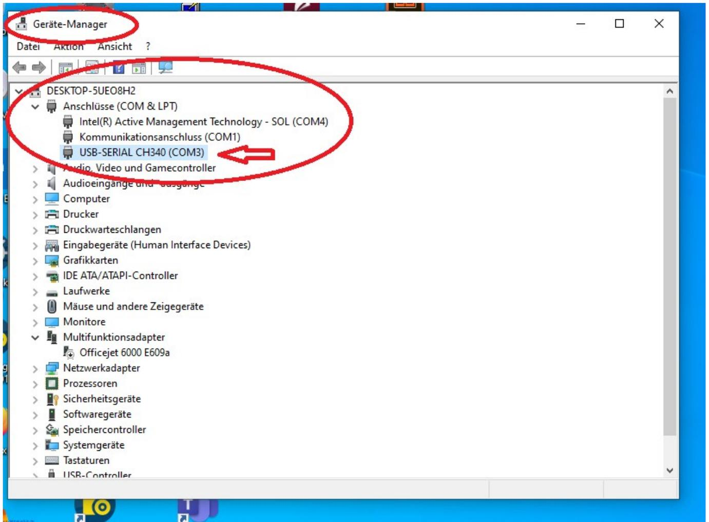
Im Falle von original Arduinos erscheint der Namen z.B. NANO. Clones werden hingegen mit dem verbauten Chip aufgeführt, hier der CH340. Das liegt daran, dass dort statt der FTDI-Chips die deutlich preiswerteren CH340G USB 2 Serial Chips verbaut werden.
