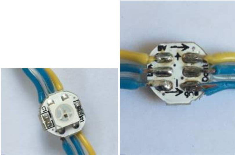
Für den ersten Versuche reicht es, einfach ein paar RGB LEDs zusammen zu löten und direkt mit den Anschlüssen des Arduino zu verbinden. Vorsichtshalber vorher den Arduino vom Computer trennen. Aber nicht übertreiben. Wenn der Arduino mit einem normalen USB-Netzteil und USB2.0 betrieben wird stehen 500 mA am 5V-Anschluss zur Verfügung. Das entspricht 5 RGB-LEDs mit maximaler Helligkeit auf allen Kanälen. Verbindet man mehr LEDs, reicht die Stromversorgung über den Arduino ggf. nicht mehr aus.
