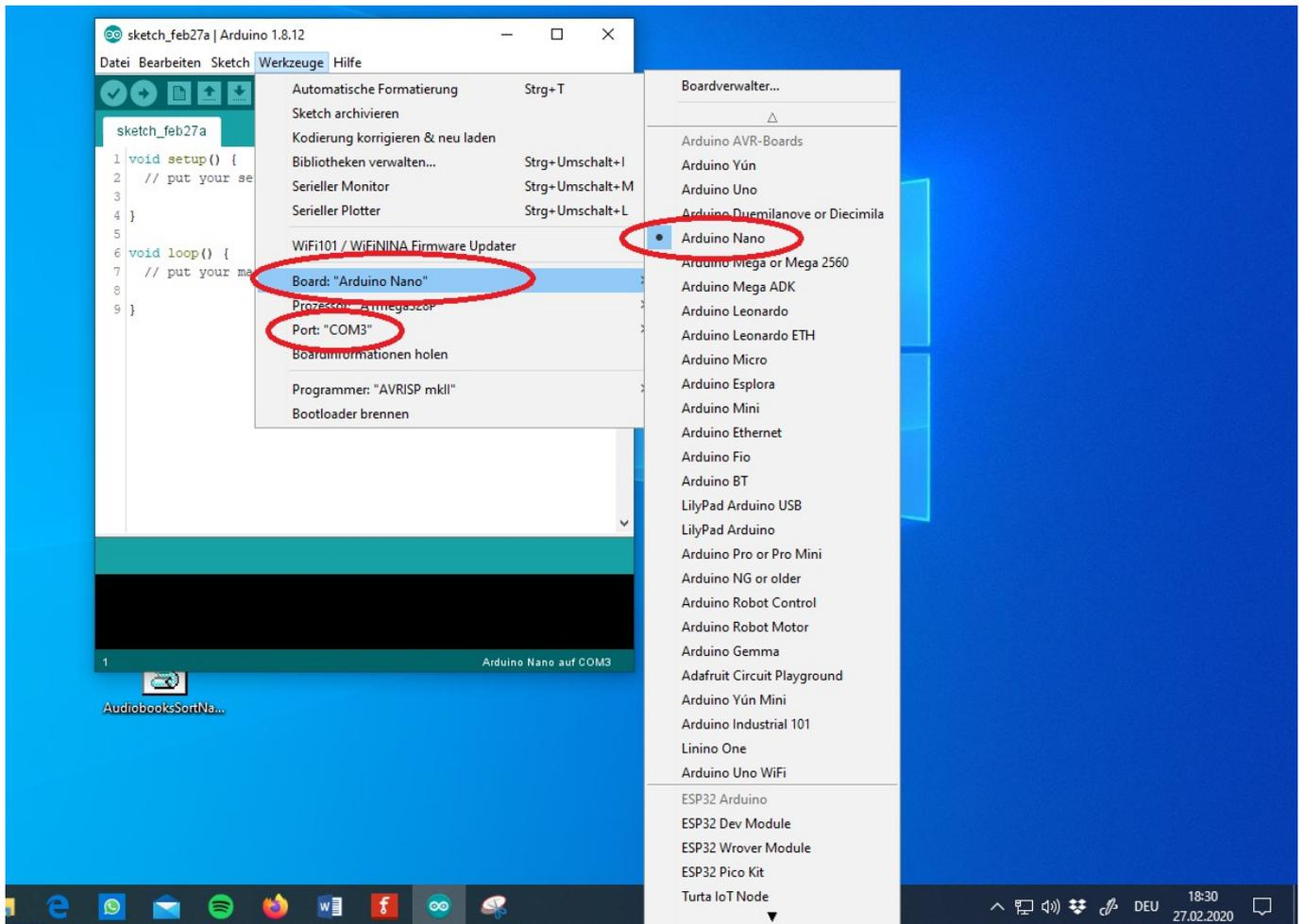
Falls das nicht der Fall ist, sollte zunächst überprüft werden, ob der Arduino erkannt wird und an welchem COM-Port er angeschlossen wurde. Dazu im WINDOWS Geräte-Manager, zu erreichen über die WINDOWS Starttaste mit rechter Maustaste anklicken, unter „Anschlüsse(COM&LPT)“ prüfen ob der Arduino dort aufgelistet ist.
