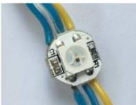
Für den ersten Versuche reicht es, einfach ein paar RGB LEDs zusammen zu löten und direkt mit den Anschlüssen des Arduinos zu verbinden. Vorsichtshalber vorher den Arduino vom Computer trennen. Aber nicht übertreiben. Wenn der Arduino mit einem normalen USB-Netzteil und USB2.0 betrieben wird stehen 500 mA am 5V-Anschluss zur Verfügung. Das entspricht 5 RGB-LEDs mit maximaler Helligkeit auf allen Kanälen. Verbindet man mehr LEDs, reicht die Stromversorgung über den Arduino ggf. nicht mehr aus.
