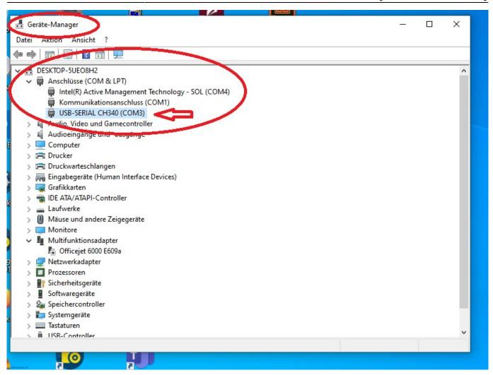
Im Falle von original Arduinos erscheint der Namen z.B. NANO. Clones werden hingegen mit dem verbauten Chip aufgeführt, hier der CH340. Das liegt daran, dass dort statt der FTDI-Chips die deutlich preiswerteren CH340G USB 2 Serial Chips verbaut werden.
