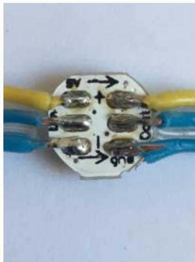
Für den ersten Versuche reicht es, einfach ein paar RGB LEDs zusammen zu löten und direkt mit den Anschlüssen des Arduinos zu verbinden. Vorsichtshalber vorher den Arduino vom Computer trennen. Aber nicht übertreiben. Wenn der Arduino mit einem normalen USB-Netzteil und USB2.0 betrieben wird stehen 500 mA am 5V-Anschluss zur Verfügung. Das entspricht 5 RGB-LEDs mit maximaler Helligkeit auf allen Kanälen. Verbindet man mehr LEDs, reicht die Stromversorgung über den Arduino ggf. nicht mehr aus.
