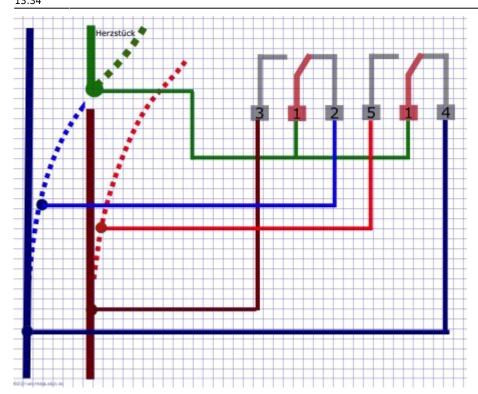
Die Mittelanschlüsse 1 werden mit dem Herzstück verbunden , Anschluss 5 und 4 gehen zu den Aussenschienen und die Anschlüsse 3 und 2 gehen zu den Zungen , der festsehende und der bewegliche Teil einer Zunge sind jeweils verbunden aber vom Herzstück getrennt.
