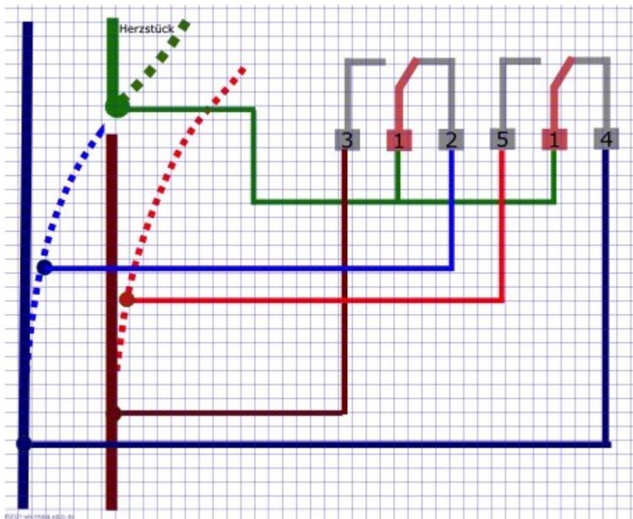
Die Mittelanschlüsse 1 werden mit dem Herzstück verbunden , Anschluss 5 und 4 gehen zu den Aussenschienen und die Anschlüsse 3 und 2 gehen zu den Zungen , der feststehende und der bewegliche Teil einer Zunge sind jeweils verbunden aber vom Herzstück getrennt.
