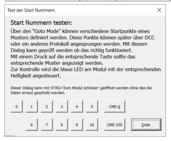
Damit kann sofort überprüft werden ob der ATtiny richtig auf Befehle reagiert. Die Befehle werden ihm (wie könnte es anders sein) per Helligkeitswerte übertragen. Die Helligkeit 15 entspricht dem Befehl 0, 35 dem Befehl 1, 55 dem Befehl 3, ... Diese Werte findet man in der Konfiguration "Charlie But Bin" wieder:
