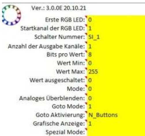
Der „Startkanal der RGB LED = 1“ definiert, dass der Servo an den Stecker SV2 angeschlossen ist.
