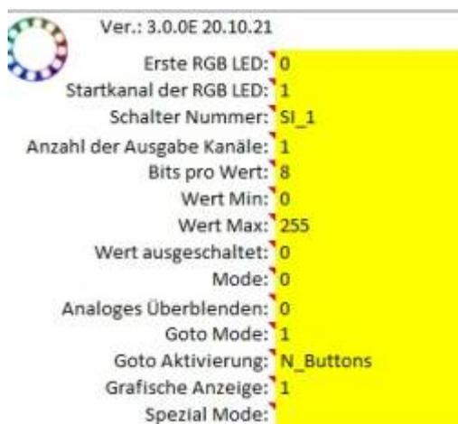
Der „Startkanal der RGB LED = 1“ definiert, dass der Servo an den Stecker SV2 angeschlossen ist. Das ist eine recht verwirrende Geschichte. Tatsächlich ist das Servo an SV1 angeschlossen, aber der ATTiny wurde versehentlich falsch konfiguriert.
