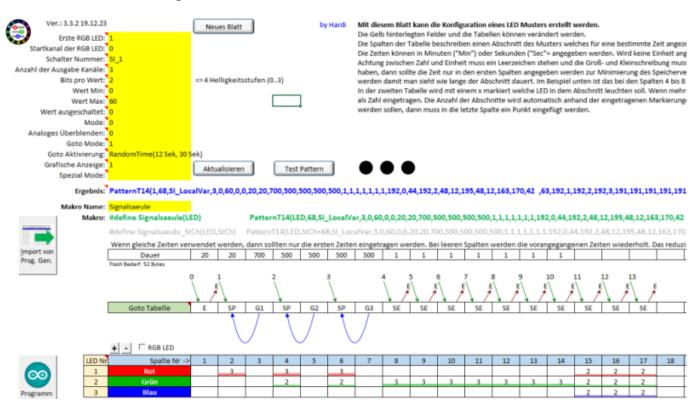
Das Ganze ist im Pattern Configurator sehr einfach abzubilden. So werden die einzelnen Zustände über eine Goto-Tabelle angelegt. Je häufiger ein Zustand eintreten soll (z. B. Grün), desto häufiger wird er als einzelner Goto-Abschnitt angelegt. Als Goto-Aktivierung kommt RandomTime zum Einsatz mit mindestens 12 Sekunden bis zur nächsten Zustandsänderung, spätestens jedoch nach 30
