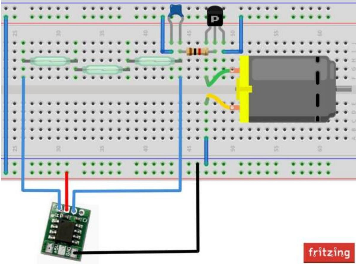
Der rote Kanal wird für 12 Sekunden aktiviert. In der Zeit fährt der Hubwagen von einem zum nächsten Reedkontakt, welcher die Stromzufuhr zum Motor unterbricht.
