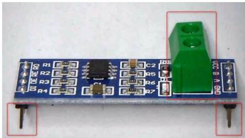
Die im Bild rot markierten Bauteile werden ausgelötet. Das sind 2 Stück 4-polige Sitztleisten und eine zweipolige Klemme.
