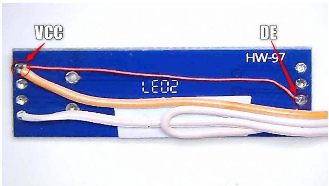
Nun kommt ein Stück transparenter Schrumpfschlauch darüber (im Bild kaum zu erkennen). Nach dem Schrumpfen werden die Kabel auf beiden Seiten mit einem Kabelbinder als Zugentlastung fixiert.
