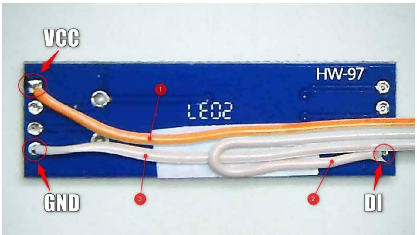
Dann wird mit einer kurzen Litze 'VCC' mit 'DE' verbunden
