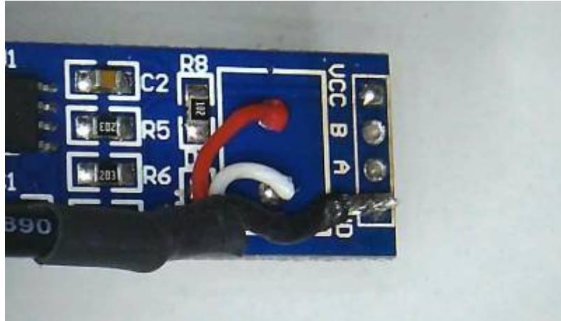
Auf der Unterseite der Platine wird das 3-polige Flachbandkabel angelötet Der markierte Pol 1 des Flachbandkabels geht nach VCC, der Pol 2 an DI und Pol 3 an GND. (Ich verwende ein Stück doppelseitiges Klebeband, um einerseits das Kabel beim Löten zu fixieren, außerdem dient es in weitere Folge als eine gewisse Zugentlastung)
