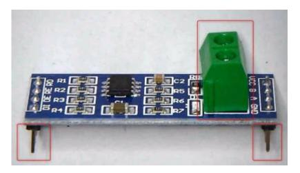
Die im Bild rot markierten Bauteile werden ausgelötet. Das sind 2 Stück 4-polige Sitftleisten und eine zweipolige Klemme.
