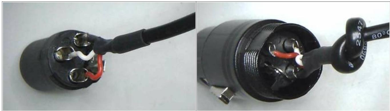
Das Mikrofonkabel wird an das Modul angelötet. Die Schirmung kommt an GND, die weiße Leitung an A und die rote Leitung an B
