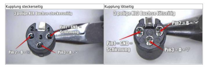
Die Schirmung kommt an Pin 1, die rote Leitung an Pin 2 und die weiße Leitung an Pin 3. Anschließend wir die Kupplung wieder zusammengebaut. Da das von mir verwendete Kabel sehr dünn ist habe ich ihm eine besondere Zugentlastung verpasst.
