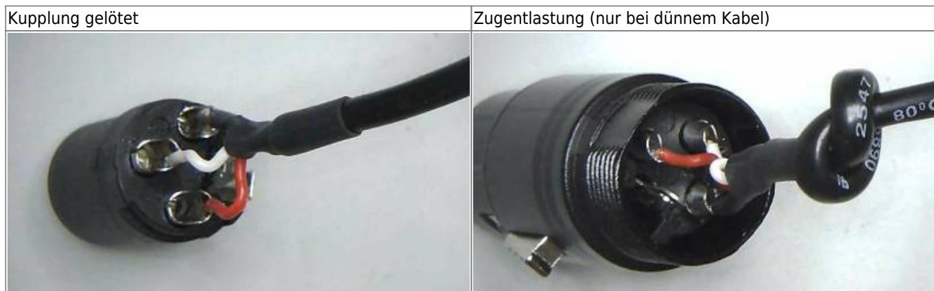
Das Mikrofonkabel wird an das Modul angelötet. Die Schirmung kommt an GND, die weiße Leitung an A und die rote Leitung an B
