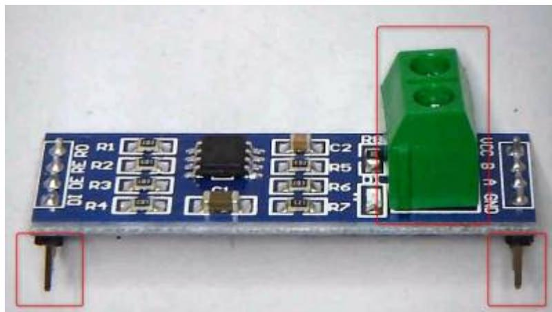
Die im Bild rot markierten Bauteile werden ausgelötet. Das sind 2 Stück 4-polige Sitttleisten und eine zweipolige Klemme.
