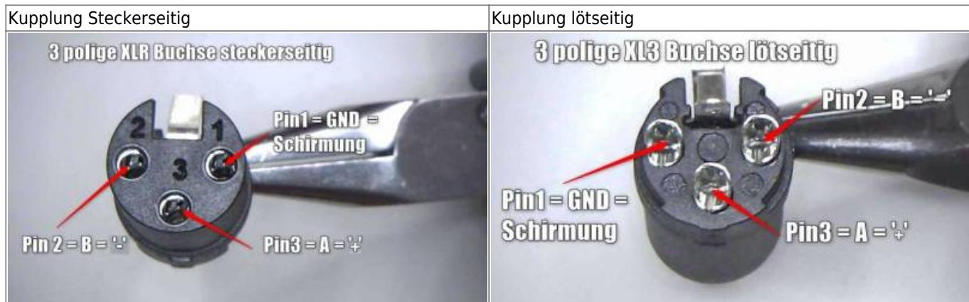
Die Schirmung kommt an Pin 1, die rote Leitung an Pin 2 und die weiße Leitung an Pin 3.
