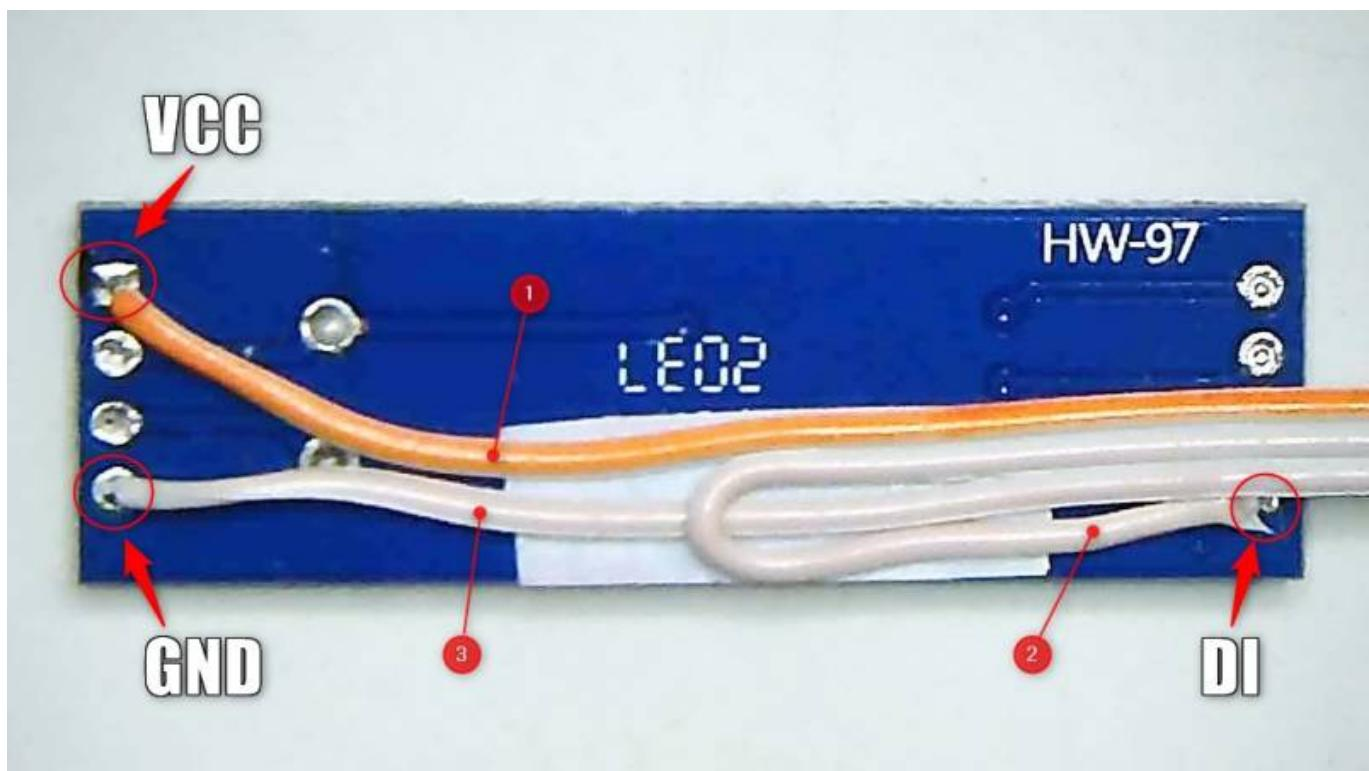
Dann wird mit einer kurzen Litze 'VCC' mit 'DE' verbunden
