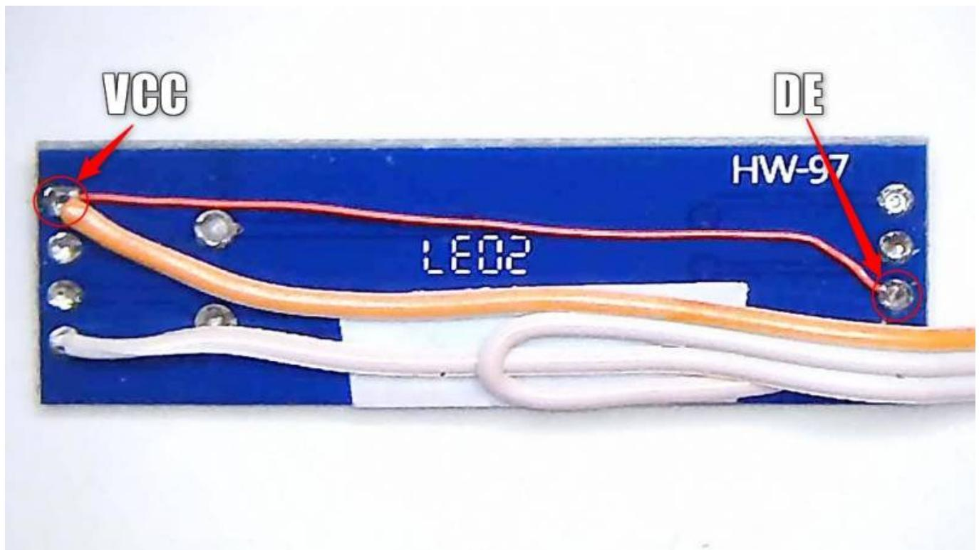
Nun kommt ein Stück transparenter Schrumpfschlauch darüber (im Bild kaum zu erkennen). Nach dem Schrumpfen werden die Kabel auf beiden Seiten mit einem Kabelbinder als Zugentlastung fixiert.
