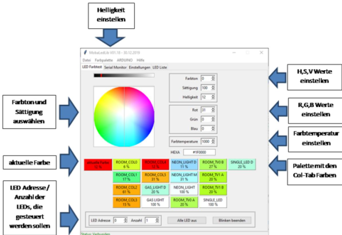
Die Farbauswahlseite erlaubt es die Wirkung einer LED-Farbe direkt zu testen. Dazu bietet sie die Möglichkeit die LED auszuwählen, die gewünschte LED-Farbe einzustellen und diese dann an den ARDUINO zu senden.
