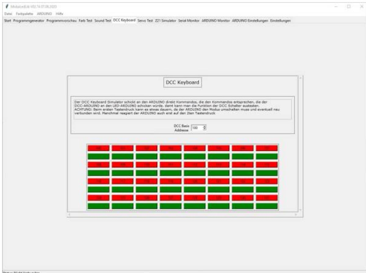
Die Basis-Adresse ist die Startadresse mit der die Taster anfangen. Ansonsten verhält sich das Keyboard wie ein normales Keyboard. Bei Druck auf die Grüne-Taste wird ein Makro, das im ProgrammGenerator mit einer DCC-Adresse als Ein/Aus Schalter konfiguriert wurde, eingeschaltet. Mit der roten Taste wird er wieder ausgeschaltet.
