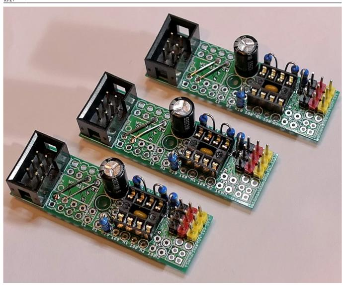
Programmieren kann man den ATTiny85, mit dem bekannten 400er Progger, aus dem Python Programm Generator heraus; fast an der selben Stelle, wie auch Hardies Variante. Es heißt dort "Servo 2"
