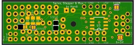
Jumper schließen: Servo, Servo2, Servo3
