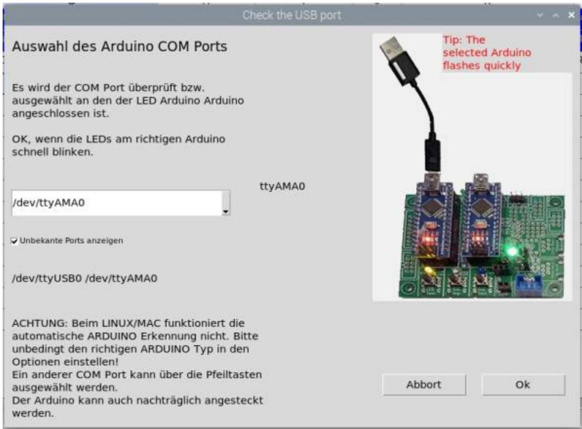
Hier den Port auswählen, bei dem der Nano erkannt wird entweder mit einem Namen oder als USB Serial:
