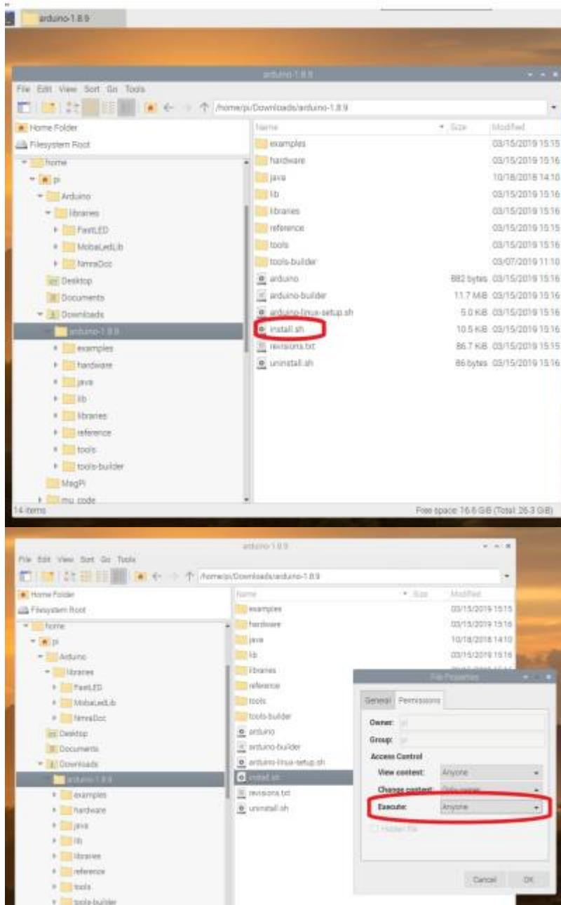
Das Installationsscript erzeugt ein Desktop Icon für die ARDUINO Benutzeroberfläche.
