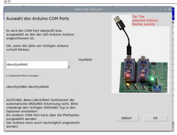
Hier den Port auswählen, bei dem der Nano erkannt wird entweder mit einem Namen oder als USB Serial:
