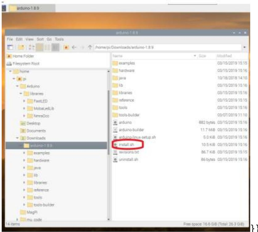
Das Installationsscript erzeugt ein Desktop Icon für die ARDUINO Benutzeroberfläche.
