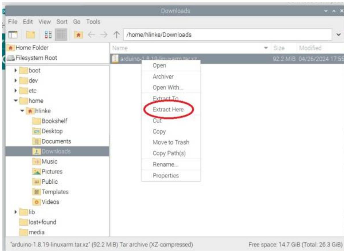
Nach dem Entpacken in das entpackte Verzeichnis wechseln und die Datei install.sh doppelt anklicken. Es kann sein, dass die Datei nicht ausgeführt werden kann. Dann auf die Datei Rechtsklicken. Die Eigenschaften (properties) auswählen. Und bei „Execute“ „Anybody“ auswählen.
