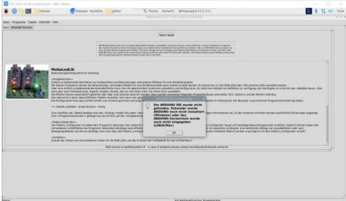
Das ist bei Linux normal, da es leider keine automatische Möglichkeit gibt, den Installationsort der ARDUINO IDE zu bestimmen. Diese Information müssen wir der pyMobaLedLib von Hand mitteilen.
