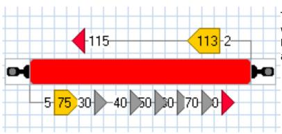
Mit dem Steuerungsprogramm TrainController von Herrn Freiwald, werden hier z. B 5 LEDs während der Einfahrt eines Zuges in einen Block aktiviert. (graue Dreiecke)
