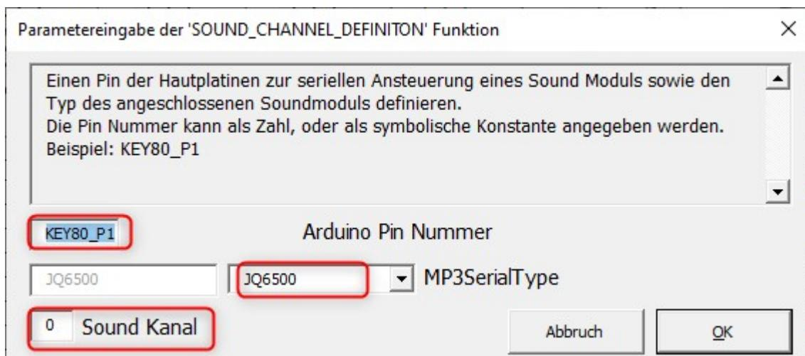
obiges Makro bedeutet, es gibt nun ein Soundmodul vom Type JQ6500, welches an Pin1 des Key80 Steckers angeschlossen ist. Hast du mehr Module wird dieses Makro mehrmals verwendet.
