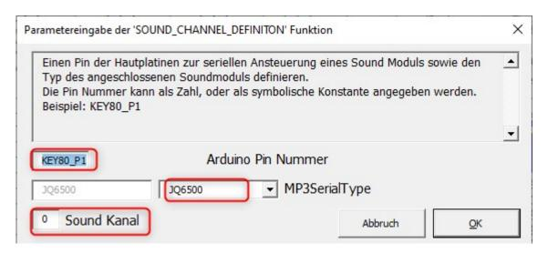
obiges Makro bedeutet, es gibt nun ein Soundmodul vom Type JQ6500, welches an Pin1 des Key80 Steckers angeschlossen ist. Hast du mehr Module wird dieses Makro mehrmals verwendet.
