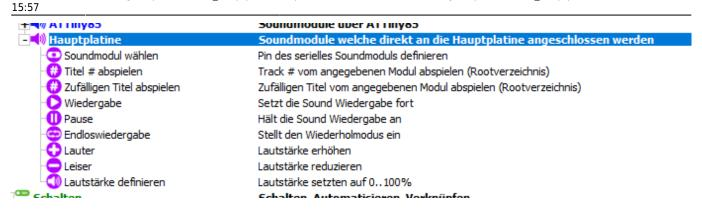
zuerst werden die Sound-Pins und Module definiert, bis zu acht sind möglich
