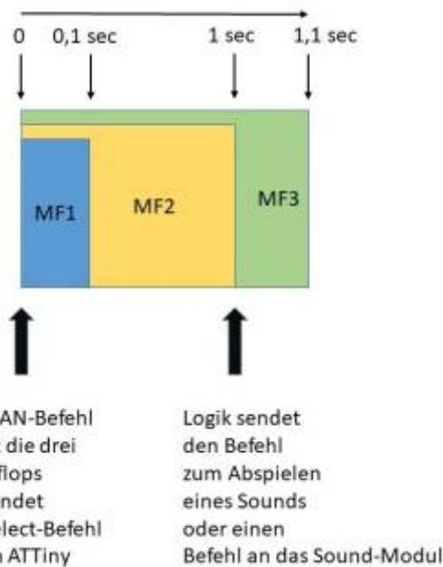
Vor jedem Sound-Befehl kann das Modul ausgewählt werden auf dem sich die Sound-Datei befindet. So können Sound-Dateien in unterschiedlicher Reihenfolge von den drei Modulen abgespielt werden. Die Logik stellt sicher, dass zunächst über den ATTiny das Modul ausgewählt wird, der Befehl umgesetzt werden kann und dann, mit zeitlichem Verzug, der Track ausgewählt oder eine andere Funktion des Moduls aufgerufen wird.
