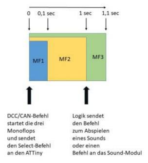
Vor jedem Sound-Befehl kann das Modul ausgewählt werden auf dem sich die Sound-Datei befindet. So können Sound-Dateien in unterschiedlicher Reihenfolge von den drei Modulen abgespielt werden. Die Logik stellt sicher, dass zunächst über den ATTiny das Modul ausgewählt wird, der Befehl umgesetzt werden kann und dann, mit zeitlichem Verzug, der Track ausgewählt oder eine andere Funktion des Moduls aufgerufen wird.
