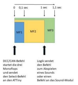
Vor jedem Sound-Befehl muss das Modul ausgewählt werden auf dem sich die Sound-Datei befindet. So können Sound-Dateien in unterschiedlicher Reihenfolge von den drei Modulen abgespielt werden. Die Logik stellt sicher, dass zunächst über den ATTiny das Modul ausgewählt wird, der Befehl umgesetzt werden kann und dann, mit zeitlichem Verzug, der Track ausgewählt oder eine andere Funktion des Moduls aufgerufen wird.
