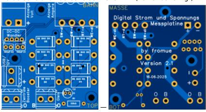
Bild der fertig bestückten Platine, mit Dioden SB840 (hier noch Version 2.0)
