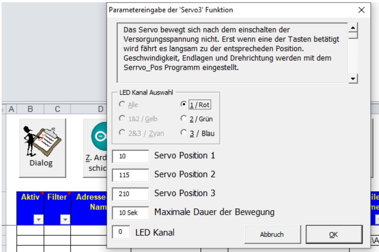
Bitte auch die Bauanleitung „510DE - Servo & LEDs“ beachten. Hier sind wichtige Tipps zu den Servoplatinen-Anschlüssen zu finden
